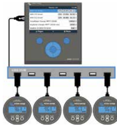
Au maximum, quatre BMV peuvent être connectés directement au Color Control. Davantage de BMV peuvent être connectés à un Hub USB pour un contrôle central.
