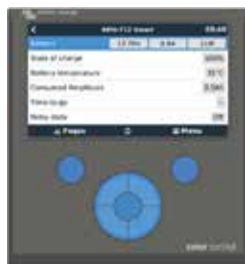
Color Control Caché derrière les boutons et l'écran couleur, le puissant ordinateur Linux rassemble les données provenant de tout équipement Victron et il les affiche à l'écran. En plus de communiquer avec l'équipement Victron, le Color Control communique à travers un bus CAN (NMEA 2000), Ethernet et USB. Les données peuvent être stockées et analysées sur le portail VRM.
