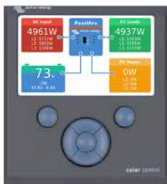
Color Control GX, montrant une application PV
